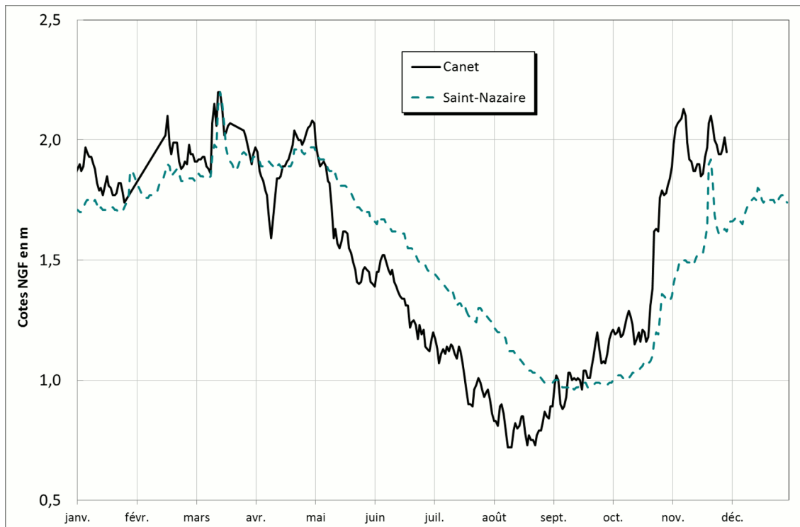
Illustration 13 : Comparaison des évolutions piézométriques enregistrées en 2010 des ouvrages situés dans le secteur de l'étang de Canet – St Nazaire.
