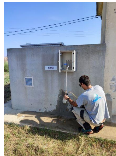
Prélèvement d'eau sur un forage AEP dans le cadre du réseau « suivi Chlorures »
