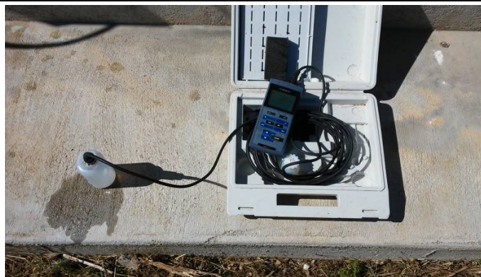
Figure 48 : Mesure de la conductivité lors des campagnes
