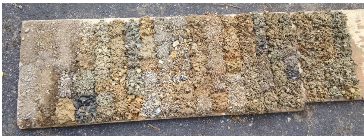
Figure 17 - Photographie des cuttings du piézomètre de Le Soler prise en fin de travaux (une rangée verticale = 3 mètres de reconnaissance)
