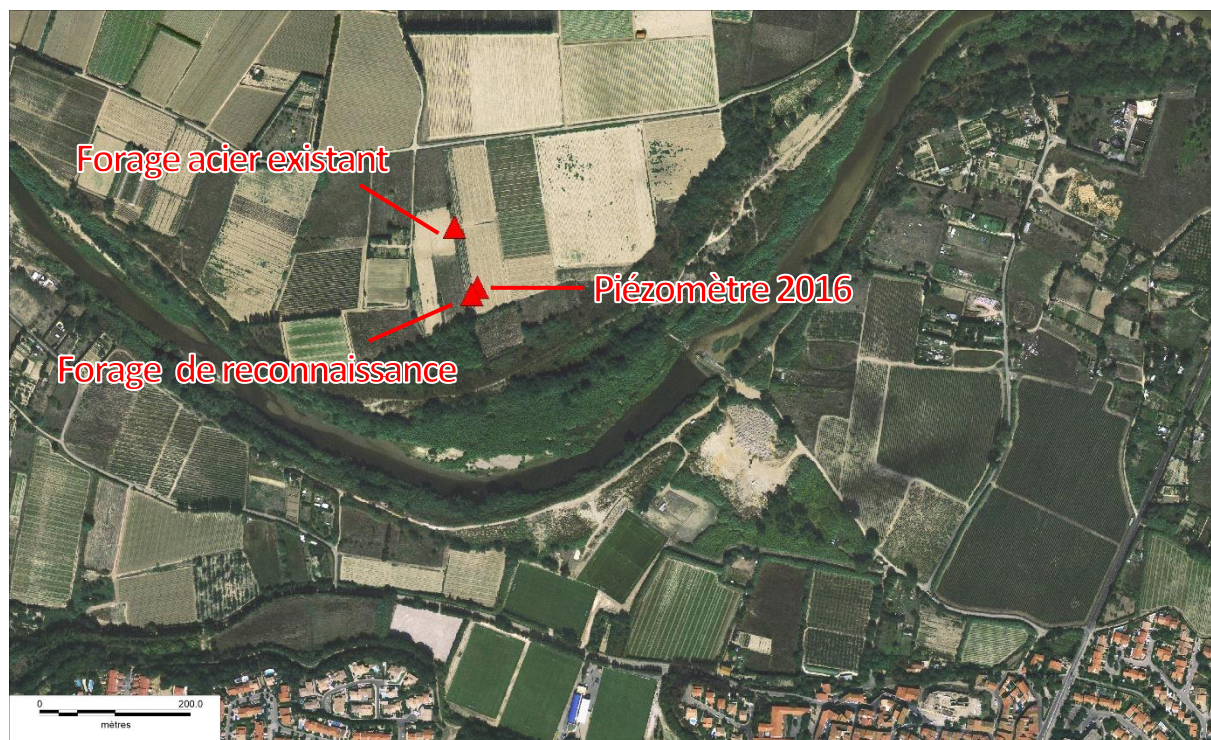
Illustration 13 - Localisation sur photo-aérienne des ouvrages du site de Sainte Marie la Mer (fond ©IGN Ortho-Photo)
